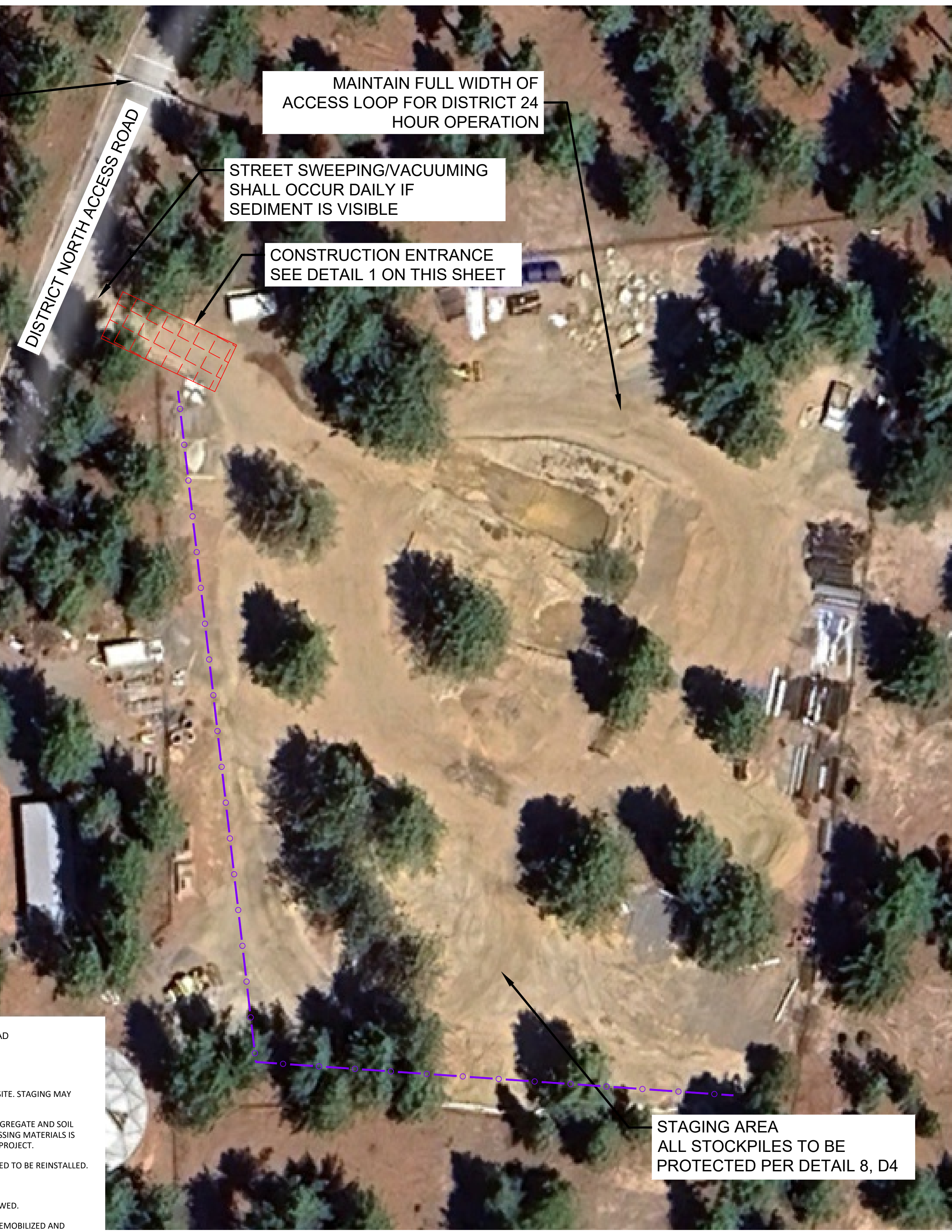
1 B2 STABILIZED CONSTRUCTION ENTRANCE/EXIT SCALE: N.T.S.
